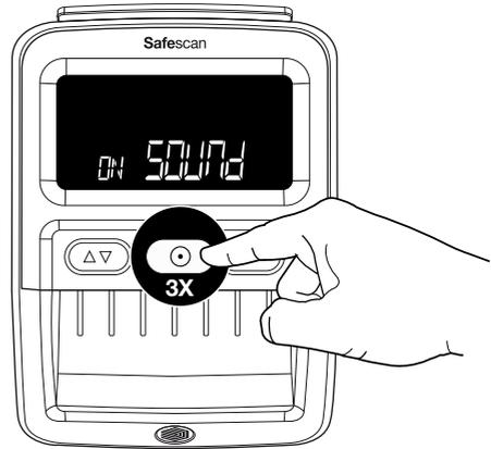
Drücken Sie die Taste
