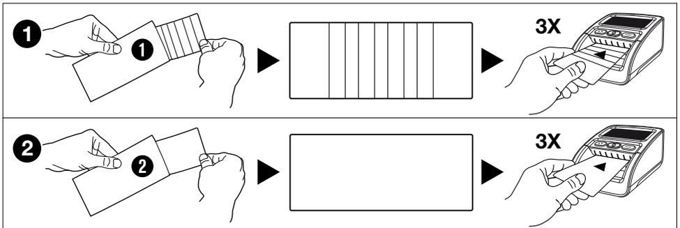
Reinigungskarten (optional) Sie können auch die Safescan Falschgeldprüfer-Reinigungskarten verwenden (Art.-Nr. 136-0545) von Safescan verwenden, um die Laufrollen und Magnetsensoren zu reinigen.
